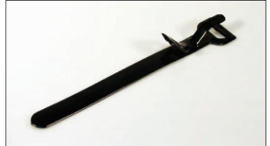
Estas abrazaderas se componen de 2 collares independientes, uno pequeño para alojar el cable portador de acero y el otro mayor para la línea. Preferentemente se usan para los cruzamientos de calles, zonas sin edificar y en tendidos aéreos suspendidos de fiador entre postes y postecillos metálicos. El sistema de cierre es de fácil colocación y máxima seguridad del tipo "Hebilla".
