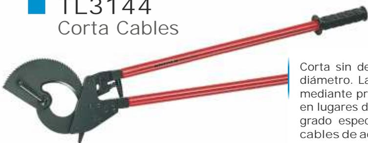
Corta sin deformar cables de cobre y aluminio hasta 100 mm. de diámetro. La cuchilla puede ser liberada a cualquier altura del corte mediante presión en la palanca de liberación. Especial para trabajar en lugares de difícil acceso. Acción de carraca y cuchillas de acero de grado especial templadas por inducción. No es adecuado para cables de acero.
