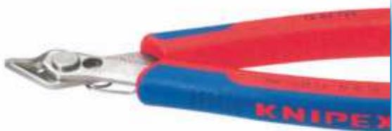
Alicates de precisión para los trabajos de corte más delicados en electrónica y mecánica de precisión. Filos de corte con rectificación, sin bisel para corte al ras. Puntas de precisa configuración para cortar también alambres colindantes a partir de 0,2 mm. de diámetro. Articulación con remache de acero de gran calidad. Movimiento extremadamente suave, evita la fatiga del operario. Con muelle y limitación de apertura.
