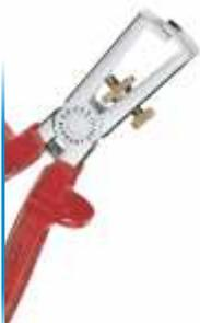
Con tornillo de ajuste para colocar el diámetro deseado, ajuste sencillo mediante tuerca moleteada colocada en el interior. Con muelle de apertura para diámetro máximo de cable 5 mm.
