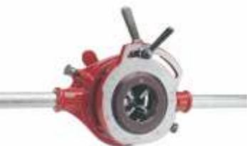
Terraaja ajustable de 1.½" A 3", doble sistema de carraca y fácil centrado del tubo. Posee amplias ventanas, que facilitan la salida de virutas proporcionando unas roscas limpias.
