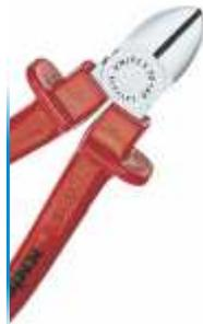
Filos de corte de precisión por inducción, para alambre blando y duro. Fabricados en acero especial al vanadio, templado al aceite. Cabeza pulida.
