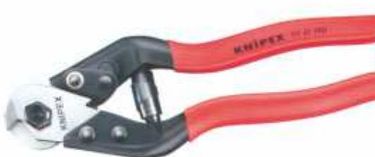
Para cables de alambre trenzado, hasta 6 mm. de diámetro, también adecuado para cables y varillas de acero. Con muelle de apertura y palanca de cierre. Filos de corte templados adicionalmente por inducción. La especial geometría de corte impide que se deshile el cable trenzado.
