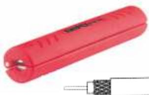
Para quitar el aislamiento y pelar todo tipo de cables convencionales de 8,0-13,0 mm de diámetro (Ej: cables de 3x1,5 mm<sup>2</sup> hasta 5x2,5 mm<sup>2</sup>). Particularmente útil para conexiones y trabajos en cajas de registro. Pela cables de doble capa. Con muelle de apertura y palanca de cierre.
