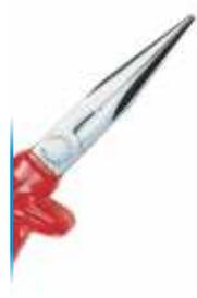
Bocas largas semi-redondas, con filos cortantes templados separadamente por inducción, fabricados en acero cromo vanadio. Aislamiento por inmersión en plástico reforzado según EN60900.
