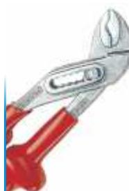
Bocas en forma de paralelogramo. Un retén protector previene que el operario se dañe los dedos. Ajuste en 7 posiciones, fabricado en acero cromo vanadio, templado al aceite. Aislamiento por inmersión en plástico reforzado según norma VDE.
