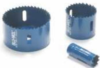
Coronas perforadoras BI-METAL acero rápido. Principales aplicaciones en acero, aluminio, cobre, hierro fundido etc... Profundidad de corte 29 a 32 mm. Filo de corte de acero rápido M3.
