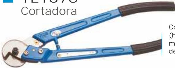
Cortadora para cables de acero (hasta 16 mm) y varillas de acero (hasta 10 mm.). De tamaño (600 mm) y peso reducido (2Kg.) los mangos son de aluminio al titanio. Cuchillas intercambiables de acero de alta calidad.
