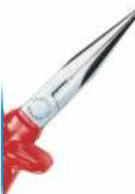
Bocas largas semi-redondas, con filos cortantes templados separadamente por inducción, fabricados en acero cromo vanadio, templados al aceite.
