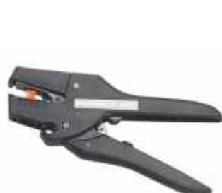
Herramienta para cortar y desaislar cables flexibles trenzados y rígidos con aislamiento de PVC para secciones de 0.08 a 6 mm<sup>2</sup>. Longitud de desaislado ajustable. Mordazas automáticas y auto ajuste de cuchillas para evitar dañar el conductor.
