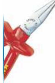
Bocas pequeñas planas, superficies de bocas rayadas, fabricado en acero especial templado al aceite. Aislamiento por inmersión en plástico reforzado según EN60900.
