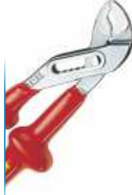
Bocas en forma de paralelogramo. Un retén protector previene que el operario se dañe los dedos. Ajuste en 7 posiciones, fabricado en acero cromo vanadio, templado al aceite. Aislamiento por inmersión en plástico reforzado según EN60900.
